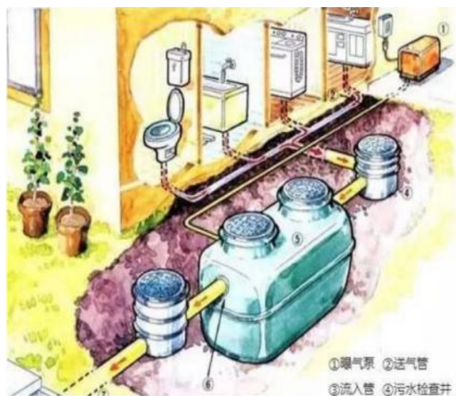
图 4.4-4 日本净化槽处理系统
