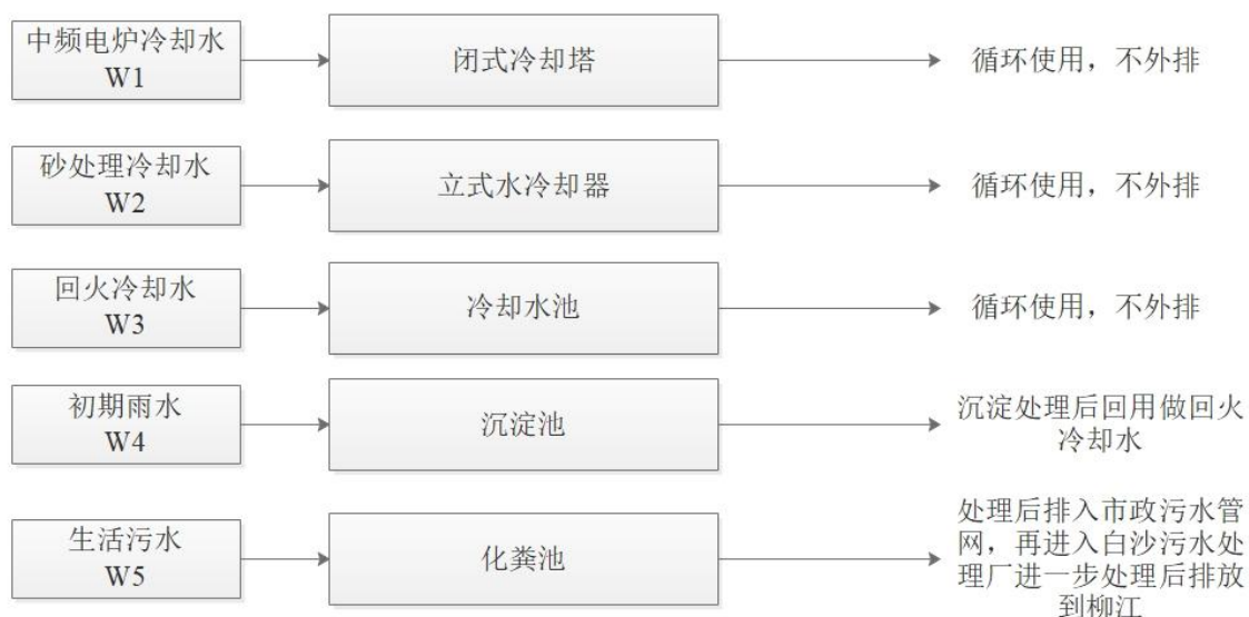
图 2-6 项目运营期废水处理环保工程工艺流程示意图
