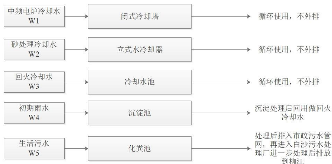
图 4-2 项目废水处理工艺流程示意图
